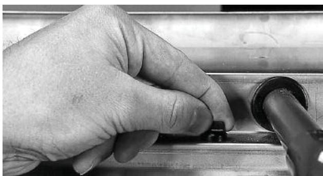
Figure 4.5 Ouvrez le couvercle de sécurité sur la tête de distribution en le tournant d'un quart de tour.
