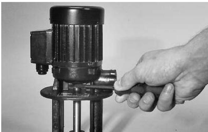
Figure 5.1 Vérification du sens de rotation
