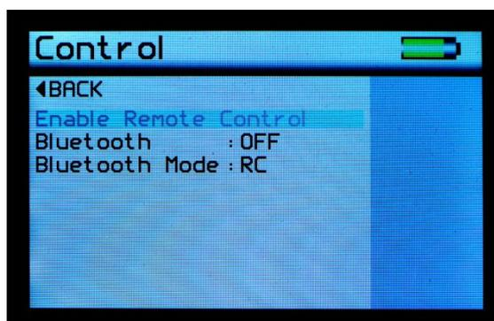
L'écran « Control » (mesure) est utilisé pour configurer les paramètres Bluetooth des instruments selon les préférences de l'utilisateur. Si vous appuyez sur les boutons haut et bas vous pouvez naviguer à travers les options, et appuyer sur le bouton « Enter » (entrée) pour sélectionner une option.
