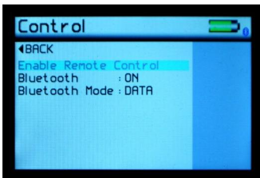
3. Si l'icône du Bluetooth n'est pas visible, activez-la, tel que décrit à l'écran « Control » (contrôle).
