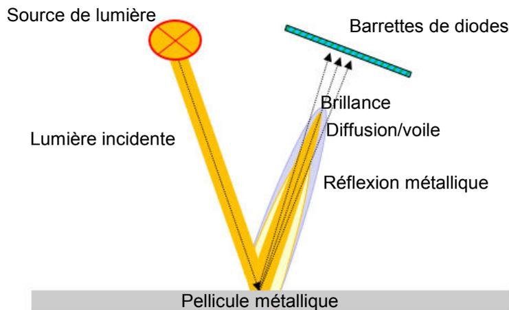
Le Rhopoint IQ capture les informations de compensation depuis une zone adjacente à l'angle de mesure de la diffusion, cela signifie que l'on peut l'utiliser sur des surfaces métalliques qui reflètent la lumière de manière directionnelle.
