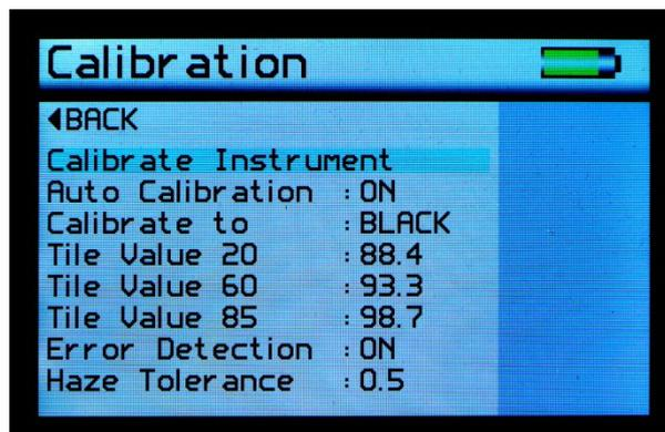
L'écran « Calibration » (étalonnage) est utilisé pour configurer l'étalonnage de l'instrument selon les préférences de l'utilisateur. Si vous appuyez sur les boutons haut et bas, vous pouvez naviguer à travers les options, et appuyer sur le bouton Enter (entrée) pour sélectionner une option.
