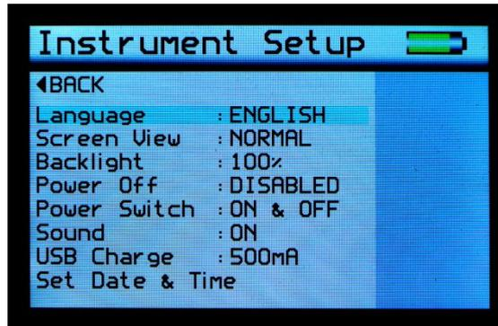
L'écran « Instrument Setup » (configuration de l'instrument) est utilisé pour configurer l'environnement d'utilisation de base des instruments selon les préférences de l'utilisateur. Si vous appuyez sur les boutons haut et bas vous pouvez naviguer à travers les options, et appuyer sur le bouton « Enter » (entrée) pour sélectionner une option.
