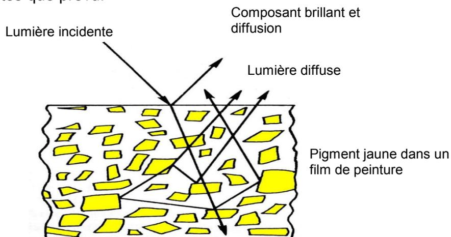
Le Rhopoint IQ compense pour la réflexion venant de l'intérieur de la pellicule pour les pigments hautement réfléchissants, les pellicules métalliques et les pigments spécialisés, permettant à la diffusion de toute surface peinte d'être mesurée.
