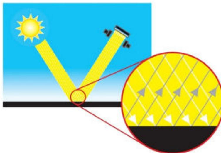
Réflexion spéculaire provenant d'une surface « miroir parfait » - toute la lumière est reflétée dans la direction spéculaire.
