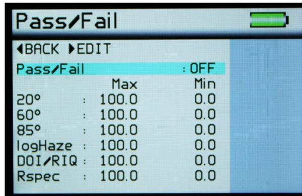
L'écran de configuration « Pass/Fail » (passe/refus) est utilisé pour activer/désactiver l'indication passe/refus sur l'écran et pour régler la tolérance min/max.
