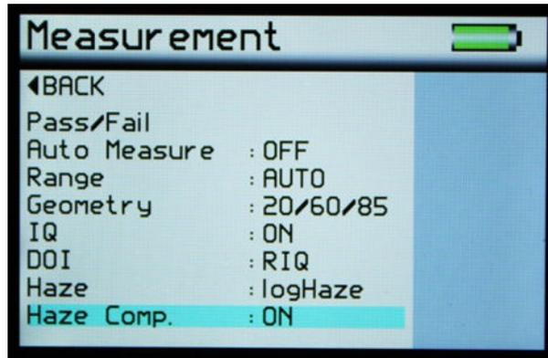
L'écran « Measurement » (mesure) est utilisé pour configurer les paramètres de mesure de l'instrument selon les préférences de l'utilisateur. Si vous appuyez sur les boutons haut et bas vous pouvez naviguer à travers les options, et appuyer sur le bouton « Enter » (entrée) pour sélectionner une option.
