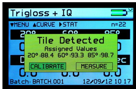
Deux options sont disponibles : pour étalonner « Calibrate » l'instrument sur la cale d'étalonnage avant d'effectuer la mesure ou de mesurer « Measure » sans effectuer d'étalonnage. En utilisant les boutons gauche/droite (3) et « Enter » (entrée) (4) sur le clavier, vous pouvez sélectionner l'option requise.
