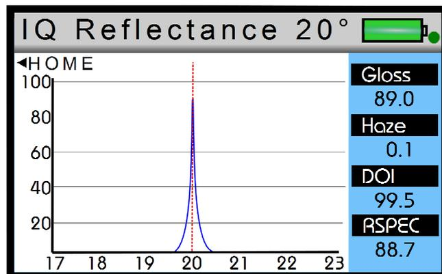
La même peinture appliquée aux deux panneaux, le deuxième système a la peau d'orange / des ondulations qui résultent du mauvais paramétrage de l'application sur le pistolet de pulvérisation. Le RSPEC est indiqué par la ligne rouge.
