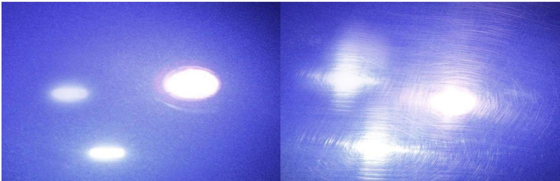
La diffusion est une mesure essentielle des métaux hautement polis et elle est souvent associée avec les marques de polissage et le sens d'usinage.
