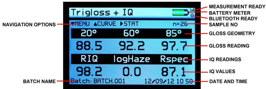
Dans ce mode, les mesures peuvent être prises en appuyant simplement le bouton de mise en marche (4) sur le clavier de l'instrument.
