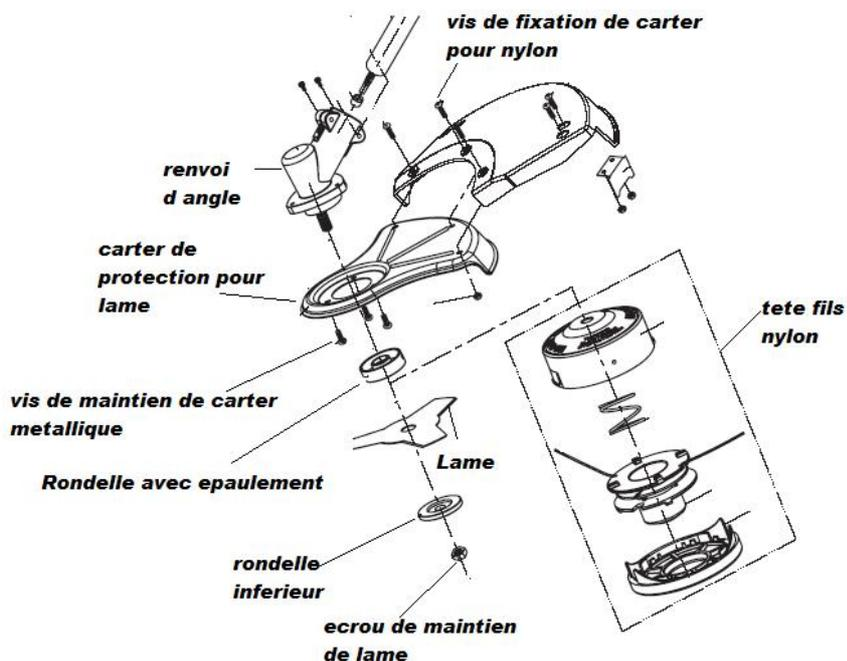
Fixer le carter de protection plastique à l'aide des 3 vis fournies sur le carter de protection métallique pour lame (après que celui-ci soit correctement monté sur la machine voir assemblage du protecteur de lame)
