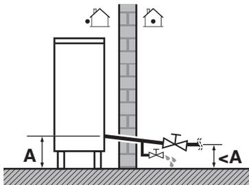
Lorsque l'alimentation est à l'arrêt à l'intérieur du système, le gel est susceptible de se produire et d'endommager le système dans le processus.
