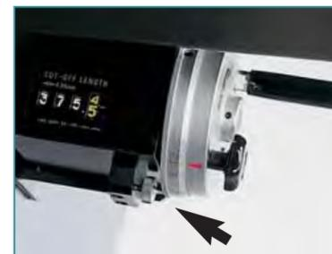
Vernier avec bague de compensation pour les grandes longueurs. (HA 250 Type W).
