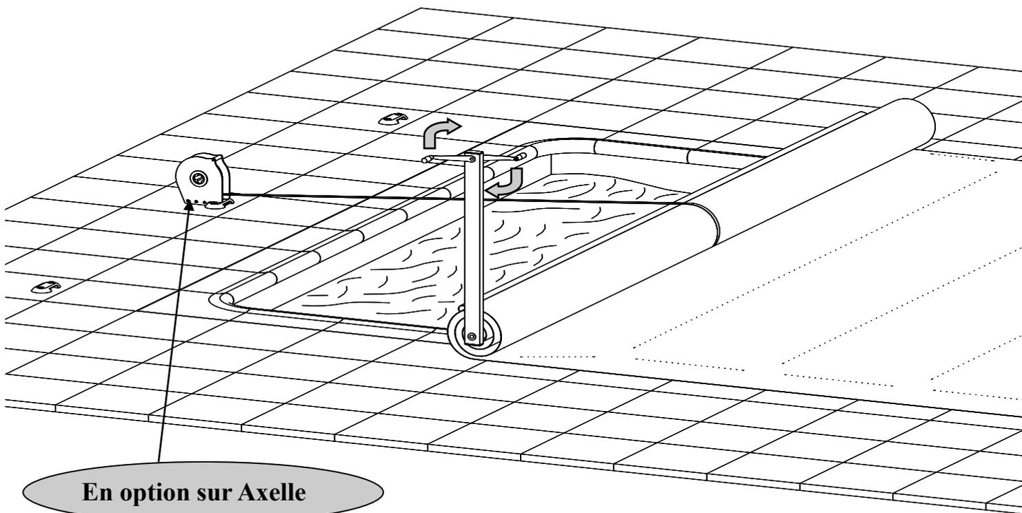
Tourner les leviers de la manivelle d'enroulement et suivre l'avancement au fur et à mesure de l'enroulement.
