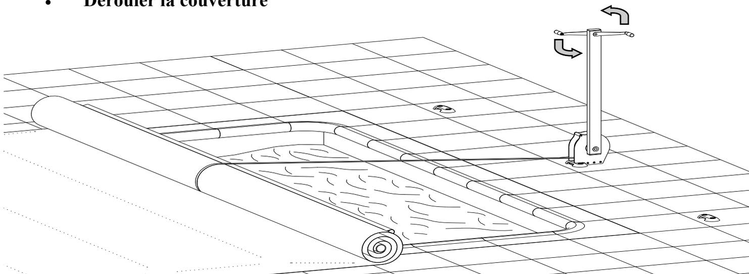
Tourner les leviers de la manivelle d'enroulement jusqu'au déroulement complet de la couverture.
