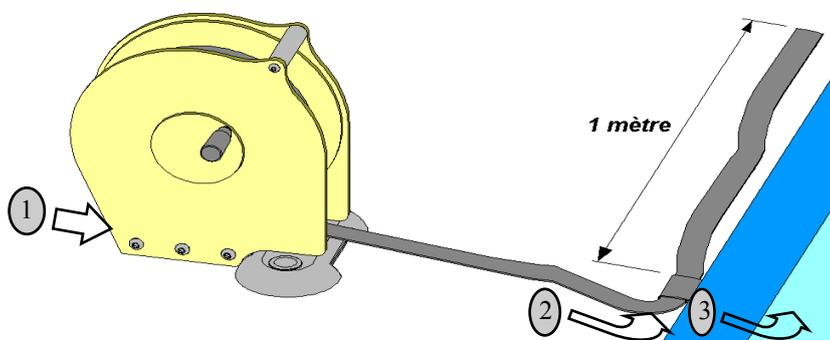
*Si vous n'avez pas choisi l'option « Enrouleur de fermeture », la sangle de fermeture sera fixée sur le tambour d'enroulement.*
