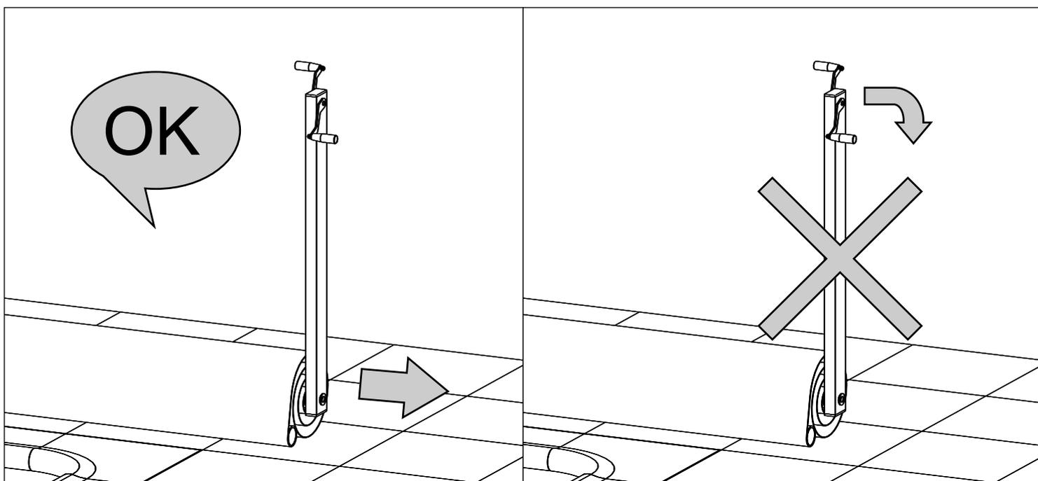
Retirer la manivelle d'enroulement en poussant la partie inférieure dans l'axe de couverture. Ne pas tirer sur les leviers de manœuvre. Stocker la manivelle d'enroulement à l'abri.
