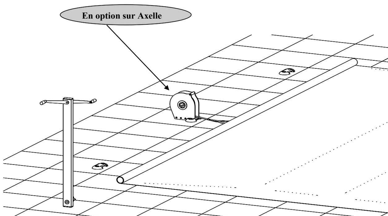
Insérer le moyeu inférieur en étoile de la manivelle d'enroulement dans l'une ou l'autre des extrémités du tube de la couverture (les deux extrémités du tube d'enroulement sont équipés pour s'adapter au mieux à votre environnement).
