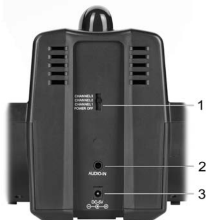
Afbeelding: Gedetailleerd aanzicht van het achterpaneel van de zendcradle
