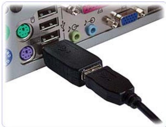
**Branchez le keylogger matériel USB entre le clavier USB et le port USB.** L'enregistrement des frappes commencera automatiquement.
