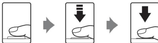
Appuyez jusqu'à mi-course sur le déclencheur pour régler la mise au point et l'exposition.
