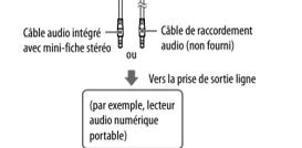
**1** Raccordez le câble audio intégré avec la mini-fiche stéréo [2] de l'appareil à la prise de sortie ligne du lecteur audio numérique portable ou autre composant\*.
