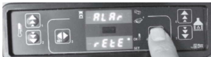
Bild 7, displayvisning efter strömavbrott
