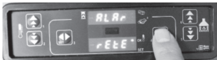
Illustration 7: écran affiché après une coupure de courant
