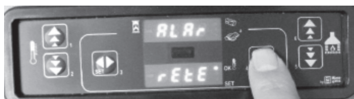
Billede 7: displayvisning efter strømsvigt
