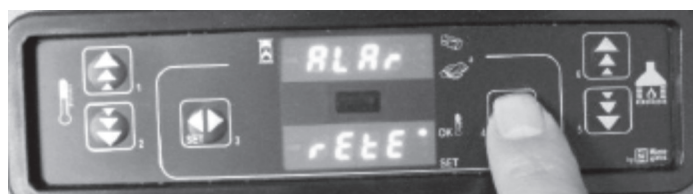
Afbeelding 7: indicatie op display na stroomonderbreking.
