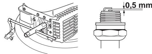
**BEMÆRK!** Brug altid anbefalet tændrørstype! Forkert tændrør kan ødelægge stempel/cylinder.
