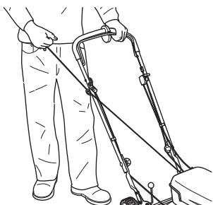
**BEMÆRK!** Træk ikke startsnoren helt ud, og slip heller ikke starthåndtaget fra udstrakt stilling. Dette kan give skader på maskinen.
