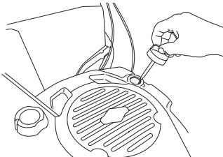
Oljepåfyllningslocket måste vara helt nerskrutat för att ge en korrekt bild av oljenivån.
