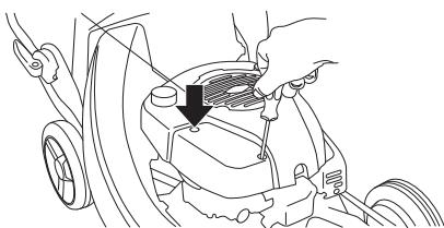
Retirer le filtre à air et contrôler qu'il est intact. S'il présente des défauts, remplacer par un filtre à air neuf.
