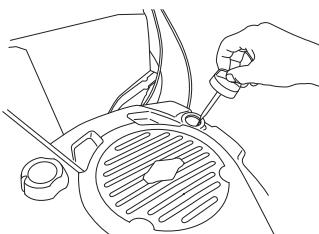
Oliepåfyldningslåget skal være skruet helt til for at give et korrekt indtryk af olieniveauet.
