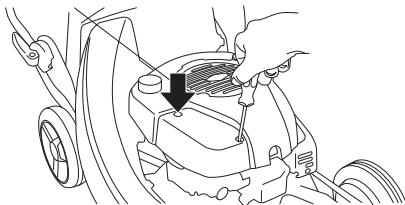
Ta bort luftfiltret och kontrollera att det är helt. Byt till nytt luftfilter om du märker att det är bristfälligt.
