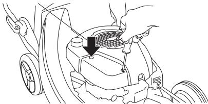
Ota ilmansuodatin pois ja tarkasta, että se on ehjä. Mikäli se on huono, vaihda uusi ilmansuodatin.
