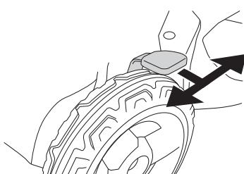
Ne pas régler la hauteur de coupe trop bas afin que la machine ne se cogne contre le sol en cas d'irrégularités de terrain.
