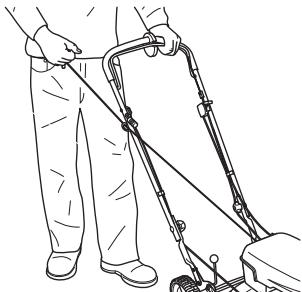
OBS! Dra ikke startsnoren helt ut og slipp heller ikke håndtaket fra helt utdratt stilling. Dette kan skade maskinen.
