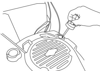
Oljepåfyllingslokket må være skrudd helt ned for å gi et korrekt bilde av oljenivået.
