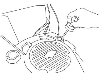
Le couvercle de remplissage d'huile doit être vissé à fond pour obtenir une mesure correcte du niveau d'huile.
