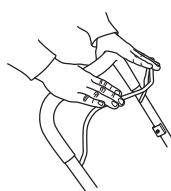
L'étrier de frein ne doit jamais être fixé de façon permanente dans la poignée lorsque la machine est en marche.
