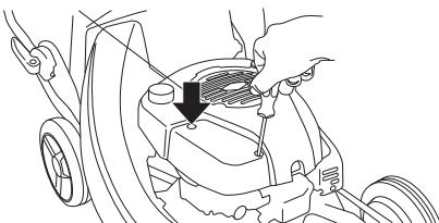
Ta av luftfilteret og kontroller at det er helt. Bytt til nytt luftfilter hvis du merker at det er mangelfullt.
