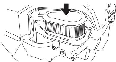
Rengjør filteret ved å banke det mot et plant underlag. Bruk aldri løsemiddel med petroleum, f.eks. parafin, eller trykkluft for å rengjøre filteret.
