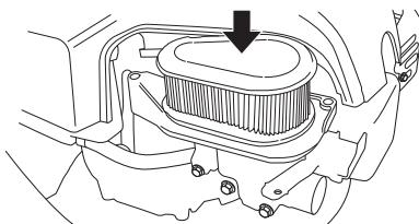
Rengör filtret genom att knacka filtret mot ett plant underlag. Använd aldrig lösningsmedel med petroleum t.ex. fotogen, eller tryckluft för att rengöra filtret.
