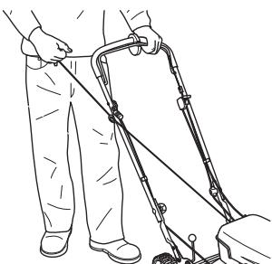
**REMARQUE!** Ne pas sortir complètement la corde du lanceur et ne pas lâcher la poignée avec la corde du lanceur complètement sortie. Cela pourrait endommager la machine.
