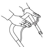
Bremsebøylen må aldri være permanent forankret i håndtaket når maskinen er i gang.
