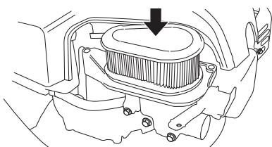
Nettoyer le filtre en le frappant contre une surface plane. Ne jamais utiliser d'agent solvant contenant du pétrole, par exemple du kérósène, ou de l'air comprimé pour nettoyer le filtre.
