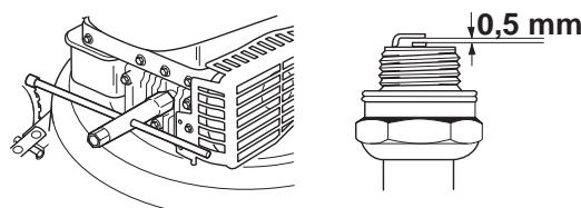
**REMARQUE!** Toujours utiliser le type de bougie recommandé! Une bougie incorrecte peut endommager le piston/cylindre.
