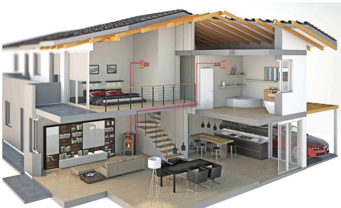
Fig. 34 - Exemple de canalisation
