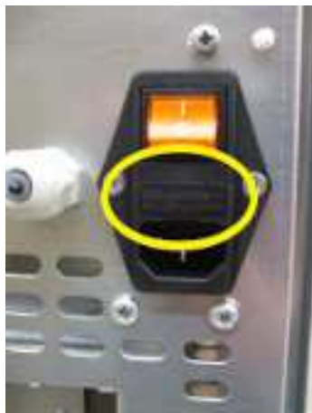
Fig. 64 - Hublot avec les fusibles à enlever
