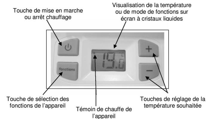
La régulation électronique de cet appareil a été conçue pour vous donner le maximum de confort et d'économie. Elle est composée d'un thermostat numérique 6 ordres « multitarif » programmable, d'un modem de pilotage 7 fonctions manuelles à commande digitale et d'un afficheur à cristaux liquides :
