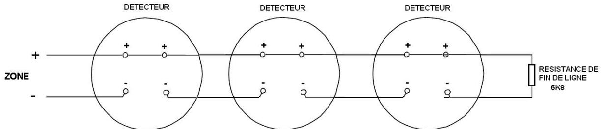
**2.2.b. Câblage de la zone 1 et 2 avec des BP ou de la zone 3 comme BP d'extinction manuelle (SW1-5 OFF)**
