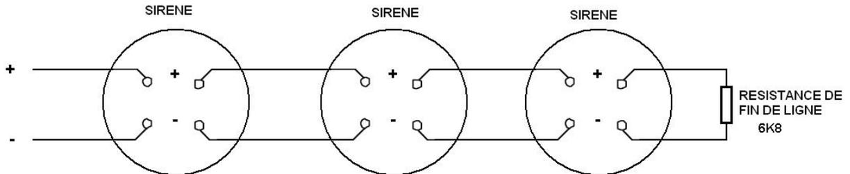
**NOTE:** Le schéma ci-dessus montre la polarité lorsque les sirènes sont activées. Lorsque les sirènes sont au repos, la polarité des sirènes est inversée.
