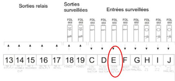
Lorsque le sélecteur SW2-5 est sur la position ON (et par conséquent l'extinction de gaz est bloquée), chaque fois que l'entrée porte ouverte est activée, les sorties suivantes seront aussi activées à condition que le central soit en état d'extinction:
