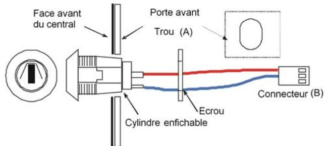
Connectez le câble au connecteur (B) et fermez le couvercle prudemment en s'assurant que les câbles ne soient pas coincés. Finalement, fixez le couvercle sur le boîtier arrière avec les vis.
