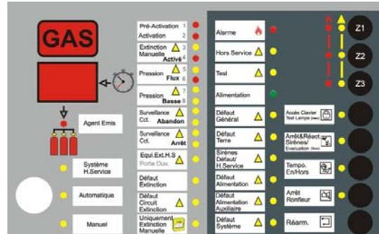
Si le compte à rebours est activé (processus d'extinction en cours) et que la porte est ouverte (avec SW2-5 en position ON), le processus d'extinction passe en mode Arrêt. Lorsque la porte est fermée, le compte à rebours redémarre de la valeur configurée dans la fonction dL.
