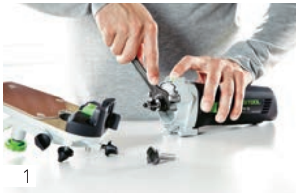
1 Commencez par monter la fraise à surfer sur la MFK 700 Basic.
