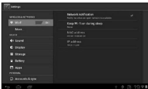
Lorsque l'option de **notification de réseau** est activée, le système lance automatiquement un scan et affiche les réseaux disponibles dans son périmètre d'accès. Si la case n'est pas cochée, vous devez appuyer sur **SCAN** pour rechercher les réseaux à proximité et appuyer sur **AJOUTER RÉSEAU** pour effectuer manuellement l'opération.
