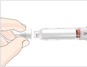
En tenant l'aiguille par le capuchon externe, poussez-la **bien droite** sur la cartouche de 6 mg et vissez-la dans le sens des aiguilles d'une montre jusqu'à ce qu'elle soit bien fixée.
