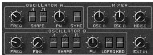
Lorsque le bouton SYNC est enclenché, la forme d'onde de l'oscillateur A redémarre à chaque début de cycle de l'oscillateur B. on utilise aussi le terme "Hard sync" (synchronisation forcée) pour désigner cette technique de
