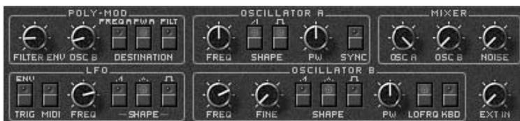
Notez que dans le module MIXER, le volume de l'oscillateur B est complètement à zéro, et que le bouton KEY B de l'oscillateur B est désactivé. L'oscillateur B est utilisé comme un "modulateur", il agit sur le son mais n'en produit pas lui même.
