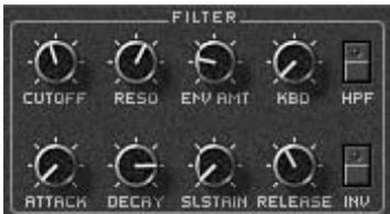
Le module FILTER du PRO-53 permet de contrôler le contenu harmonique du signal à l'aide d'un filtre résonnant passe-bas de -24 dB/octave. En plus de contrôler la fréquence de coupure (Cutoff Frequency) et la résonance du filtre (RESONANCE), ce module inclut une enveloppe avec effet de modulation variable.
