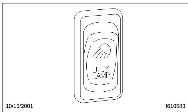
Fig. 5.11, Interrupteur de l'éclairage de commodité
