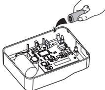
❷ Connectez la **pile principale** au circuit imprimé
