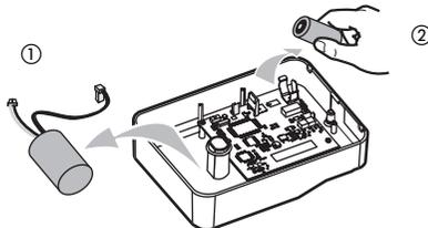
❸ Remplacez les piles des périphériques (si nécessaire)
