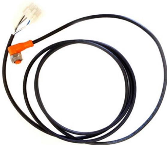
Le faisceau d'écran est un faisceau de 2 mètres (6,5 pieds) de long avec un connecteur à 4 broches sur une extrémité. Ce faisceau ne doit pas être confondu avec le faisceau d'attache-capot, car ils disposent tous deux du même connecteur sur une extrémité. Les faisceaux sont clairement identifiés avec une étiquette pour éviter d'installer le mauvais câble.
