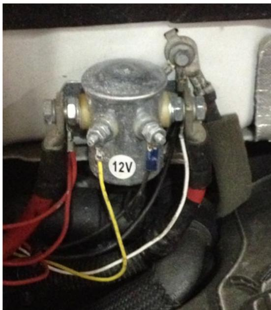
**1.** Veuillez consulter les renseignements sur le montage du solénoïde dans la section « Équipement optionnel » s'il n'est pas encore monté. Un fil de terre devra être relié depuis un goujon de circuit à l'avant du solénoïde à la borne négative principale de la batterie ou sur un emplacement adéquat du châssis relié à la terre.
