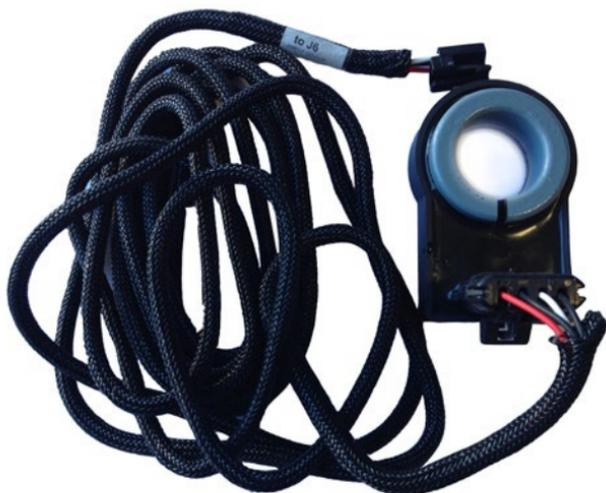
Le capteur de courant peut être installé pour maintenir le moteur du véhicule en marche en cas de charge électrique lourde telle que des onduleurs. Une fois que le moteur a démarré en basse tension et si la charge dépasse 37,5 A, le moteur continuera à tourner jusqu'à ce que la charge soit partie.
