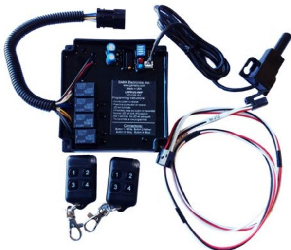
L'activation à distance de l'appareil de chauffage est ajoutée au véhicule pour permettre au conducteur de démarrer l'appareil de chauffage auxiliaire et le moteur en appuyant sur le bouton d'un plip. L'option d'activation à distance compte un module de relais, un plip et un faisceau connecté. Le faisceau connecté peut être relié au connecteur J13 sur le faisceau principal. Veuillez consulter les instructions relatives à l'option d'activation à distance.
