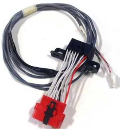
La connexion CAN (Controller area network) permet au système de commande GRIP de demander des informations à l'ordinateur de bord. Ce faisceau est conçu pour correspondre en série aux connecteurs existants du véhicule.
