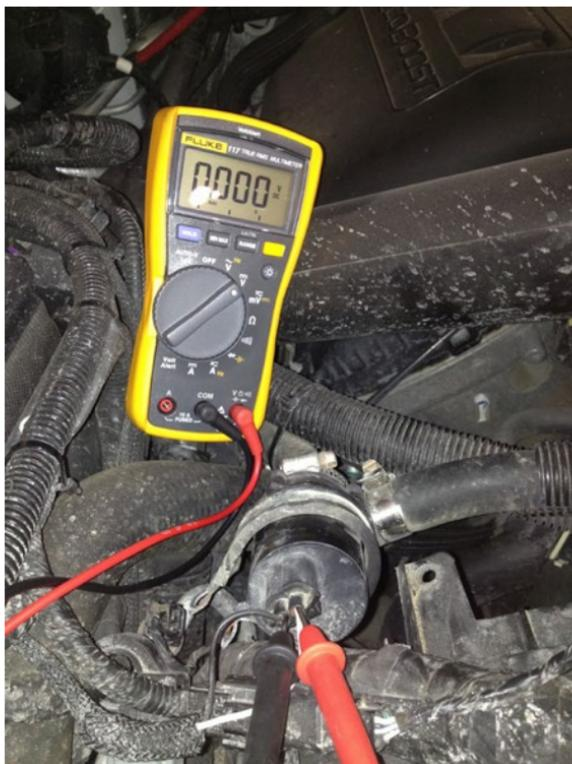
6. À l'aide d'un multimètre, vérifiez la tension de la pompe de refroidissement en poussant les câbles vers l'arrière du connecteur. Assurez-vous que le connecteur est branché à la pompe lorsque vous effectuez ce test. Le blanc est positif et le noir négatif. Vous devriez voir la tension de la pompe lorsqu'elle est en marche.
