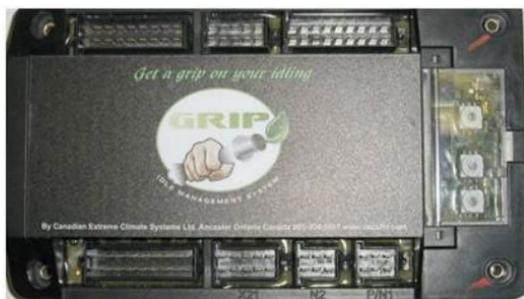
Le système de commande est le « cerveau » du système GRIP : c'est lui qui prend les décisions en fonction des programmes installés et des données transmises par le véhicule et le conducteur. Tout équipement installé doit être connecté au système de commande par ses faisceaux de câblage.
