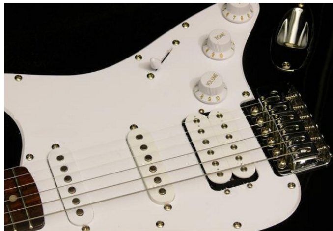
FIGURE 7 – Position des micros sur une guitare Fender Stratocaster comprenant un humbucker (micro double bobinage) et deux micros simples.
