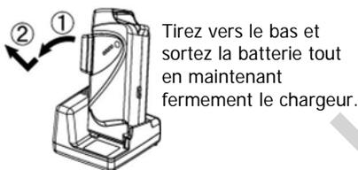
Retirez la batterie du chargeur après avoir vérifié que toutes les LED ne sont pas allumées (charge complète). Vous pouvez maintenant débrancher la prise du chargeur de l'alimentation électrique (AC 220 - 240 V).
