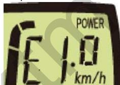
Dans ce cas, vous devez arrêter (OFF) et remettre en marche (ON) le système d'entraînement avec le bouton POWER sans exercer de pression sur les pédales. L'erreur sera alors rectifiée.
