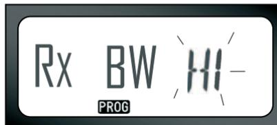
Pour programmer la largeur de bande désirée (HAU = 25kHz, BAS = 12,5kHz), utilisez les boutons  $\oplus$  /  $\ominus$  pour atteindre la valeur désirée. Appuyez longuement sur le bouton PTT pour sortir et sauvegarder, ou appuyez brièvement sur le bouton PTT pour aller à la prochaine fonction de programmation sans sauvegarder.
