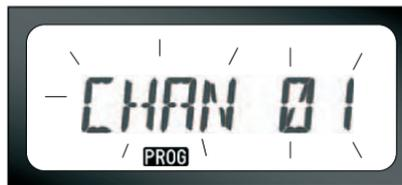
En 'Mode programmation', votre radio est capable de régler les valeurs pour chaque canal en se déplaçant dans les différents modes de programmations disponibles : Les fréquences, les codes CTCSS/DPL (code éliminateur d'interférences), le brouillage, la largeur de bande, le nombre maximum de canaux, la sonnerie d'appel, le gain du téléphone et le balayage.
