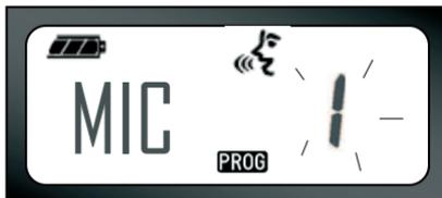
Le réglage actuel du niveau de gain du microphone accessoire clignotera. Vous pouvez sélectionner le niveau de gain désiré (1 = gain faible, 2 = gain moyen ou 3 = gain élevé) en appuyant sur les boutons  $\oplus$  /  $\ominus$ . Une fois que vous avez sélectionné le niveau de gain que vous voulez programmer, appuyez longuement sur le bouton PTT pour sortir et sauvegarder, ou appuyez brièvement sur le bouton PTT pour aller à la prochaine fonction de programmation sans sauvegarder.
