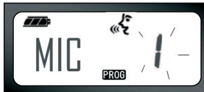
Appuyez sur les boutons MENU autant de fois que c'est nécessaire jusqu'à ce que la radio affiche les lettres « MIC » et fasse clignoter le gain actuel du microphone.
