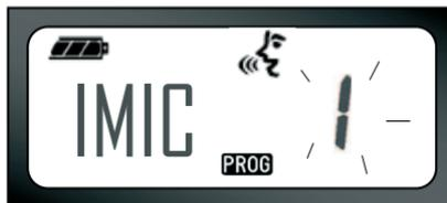
Le réglage actuel du niveau de gain du microphone clignotera. Vous pouvez sélectionner le niveau de gain désiré du microphone en appuyant sur les boutons  $\oplus$  /  $\ominus$  (1 = gain faible, 2 = gain moyen ou 3 = gain élevé). Une fois que vous avez sélectionné le niveau de gain que vous voulez programmer, appuyez longuement sur le bouton PTT pour sortir et sauvegarder, ou appuyez brièvement sur le bouton PTT pour aller à la prochaine fonction de programmation sans sauvegarder
