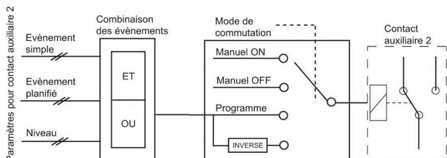
Dans les définitions suivantes, chaque paramètre possède deux numéros de référence. La référence de gauche se rapporte au contact auxiliaire 1 et la référence de droite au contact auxiliaire 2 ({référence du contact auxiliaire 1} {référence du contact auxiliaire 2}).
