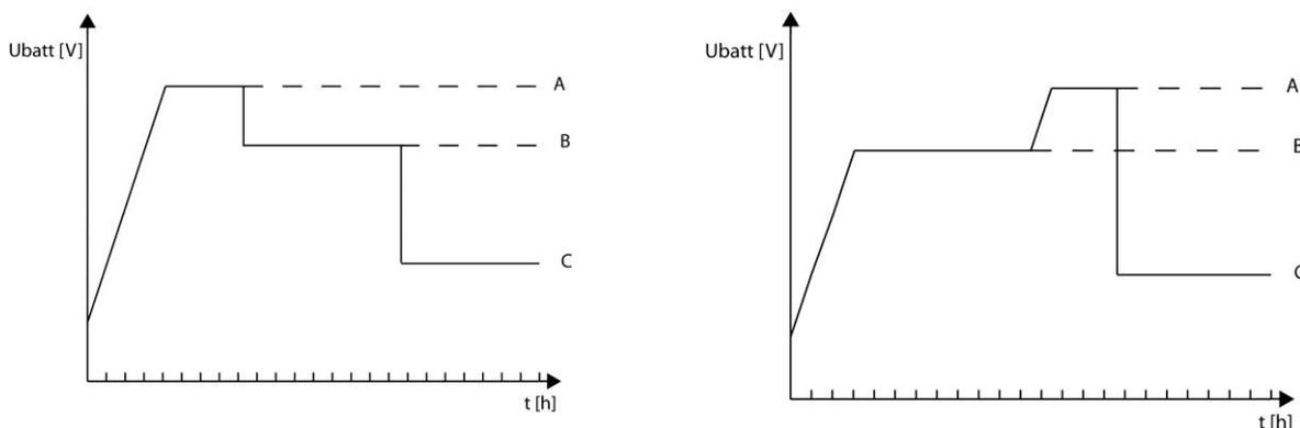
A= tension d'égalisation, B= tension d'absorption, C= tension de maintien
