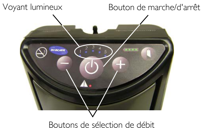
FIGURE 6.9 Ajustement du réglage du débit pulsatoire
