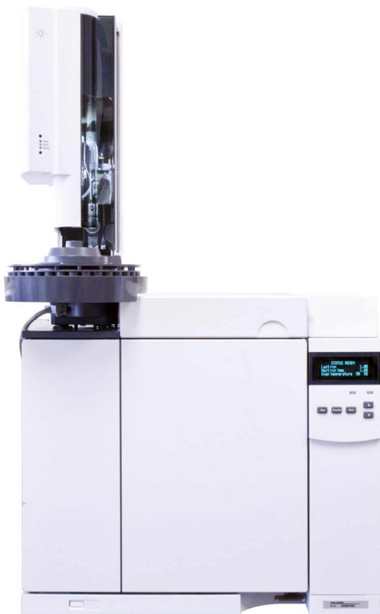
Figure 19 ALS installé sur un CPG 7820A
