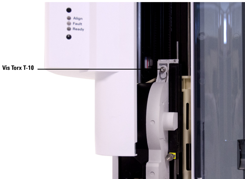
Figure 69 Fixation de la vis Torx T-10 sur le dessus du chariot de la seringue
