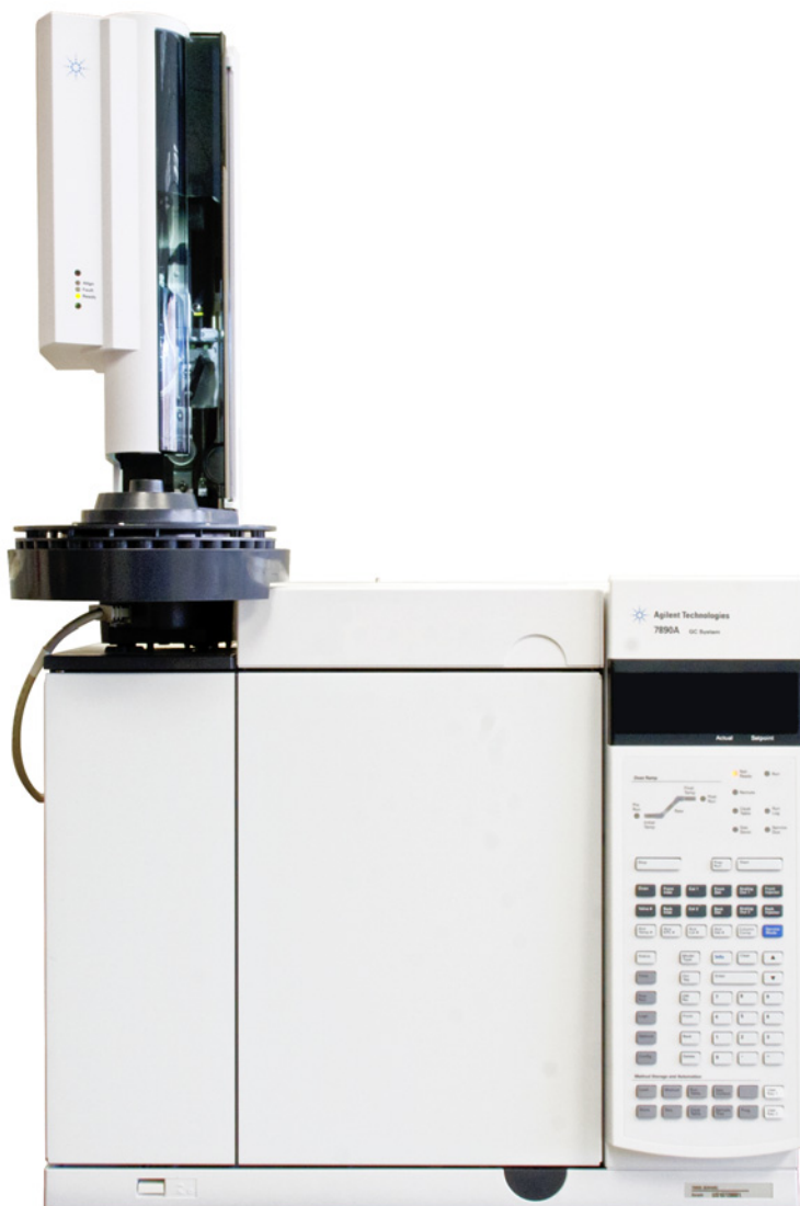
Figure 18 ALS installé sur un CPG 7890A
