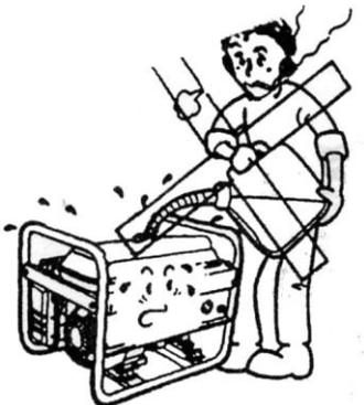
6. Quand on ravitaille la machine ,le fonctionnement de la machine doit arrêté .
