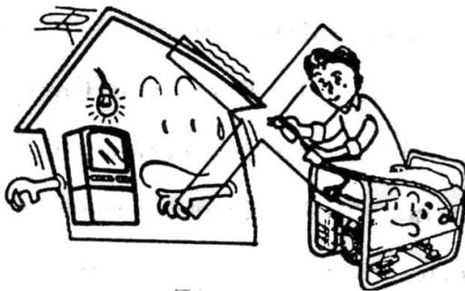
4. Laissez les matières combustibles être séparées de la machine d'une distance de plus de 1 mètre .
