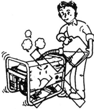
7. Quand on ravitaille la machine, l'essence ne doit pas déborder du réservoir et sur la machine .
