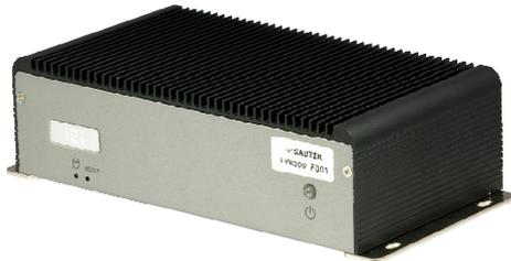
novaWeb est un serveur Web intégré permettant de visualiser votre installation au moyen d'un navigateur Web standard. Une attention particulière a été pr etee   l'interface simple ([HTML](#) pur, sans [ActiveX](#), [Java](#),...) afin de permettre un acc s rapide, y compris au moyen d'appareils tr s simples tels que les [smartphones](#) (t l phones intelligents). Selon votre niveau de connexion, vous pouvez
