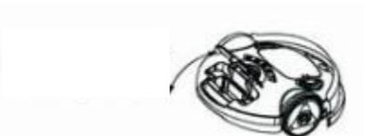
3、 Insérez la batterie à son emplacement comme montré dans le schéma ci-dessous.
