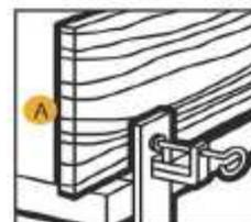
5. Placez la face du gabarit vers le bas sur le chant de la planche « A », effectuez une rotation pour que les deux pieds de centrage touchent les 2 côtés de la planche. Le trou se trouve automatiquement au centre du bois et est prêt à être percé. Utilisez la perceuse électrique ou sans fil pour percer le premier trou de goupille, puis déplacez le gabarit et répétez jusqu'à ce que tous les trous soient percés.
