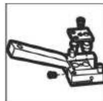
Note : pour les assemblages C-C et C-A, insérez le guide-douille plastique dans le logement du guide douille. Pour les assemblages C-S, insérez le support en L et la poignée dans le gabarit et fixez avec une vis.
