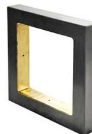
Les règles en carbure de silicium Si-Sic sont fournies dans les dimensions indiquées dans le tableau ci-dessous et sont rodées en classe 000. Elles garantissent une stabilité dimensionnelle et une meilleure résistance à l'usure et sont aussi très légères par rapport aux règles en granit. Elles sont donc idéales pour une utilisation dans les domaines de la métrologie et des machines-outils.
