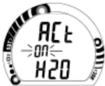
**Fig. 40** - Réglage de l'activation par immersion
