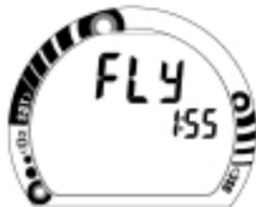
Fig. 70 - Temps d'interdiction de vol
