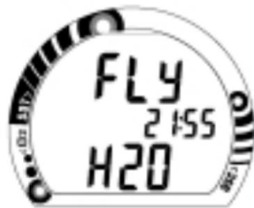
Fig. 76 - Temps d'interdiction de vol (contacts humides).
