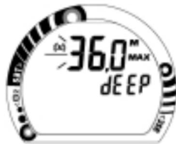
**Fig. 25** - Réglage de l'alarme de profondeur max.
