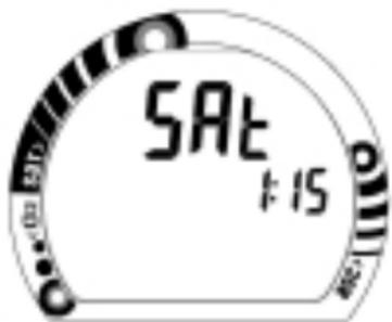
Fig. 71 - Temps de désaturation
