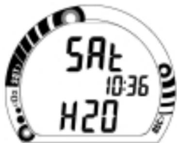
Fig. 77 - Temps de désaturation (contacts humides).
