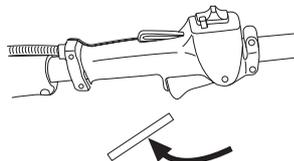
Appuyer sur le blocage de l'accélération et vérifier qu'il revient de lui-même en position initiale quand il est relâché.
