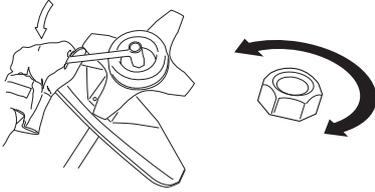
L'usure du verrouillage nylon du contre-écrou ne doit pas être telle qu'il peut se visser à l'aide des doigts. Le verrouillage doit résister à 1,5 Nm au moins. Remplacer le contre-écrou après une dizaine de serrages.
