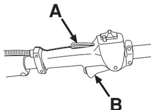
Vérifier d'abord que la commande de l'accélération est bloquée en position de ralenti quand le blocage de l'accélération est en position initiale.
