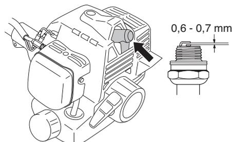
**REMARQUE!** Toujours utiliser le type de bougie recommandé! Une bougie incorrecte peut endommager le piston/le cylindre. S'assurer que la bougie est dotée d'un antiparasites.
