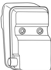
Le risque d'incendie est important dans les pays au climat chaud et sec. C'est pourquoi nous avons équipé certains silencieux de grilles antiflamme. Vérifier si le silencieux de la machine est muni d'un tel dispositif.
