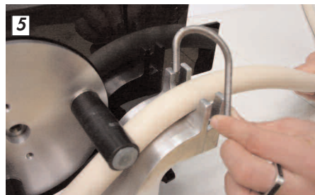
5 Sans relâcher la tension exercée sur le tube positionner ce dernier sur le second support
