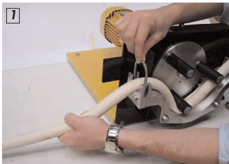
1 Disposer le tube dans l'un des 2 supports
