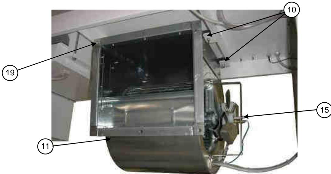
3. déconnecter les raccordements électriques du boîtier
