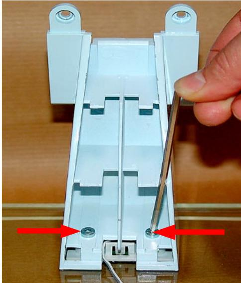
3. Vissez la clé et les vis ALLEN ci-jointes sur le pied en verre. Veuillez noter que le câble d'éclairage de la base de la station est introduit de côté, tel qu'indiqué sur la photo, pour éviter qu'il ne soit écrasé.
