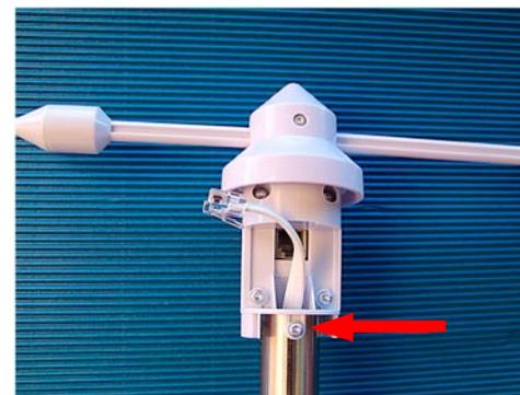
3. Insérez le pied sur le tuyau de support et tournez-le de façon à ce qu'il puisse être vissé sur le tuyau grâce aux deux vis livrées à cet effet.
