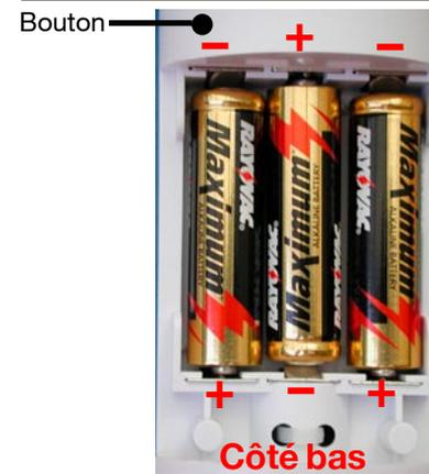
Insertion des piles, emplacement du bouton Capteur combi monté
