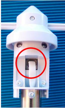
4. Insérez la fiche dans le mât de fixation de l'anémomètre
