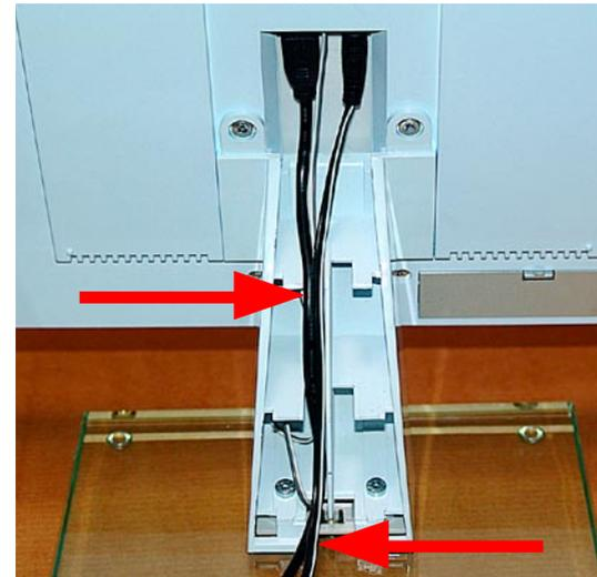
6. Les câbles sont maintenant connectés et insérés dans le pied de la station qui leur sert de support. Vérifiez que les câbles se situent bien au milieu du pied de la station, comme indiqué sur l'image, afin de ne pas empêcher la fermeture du couvercle.
