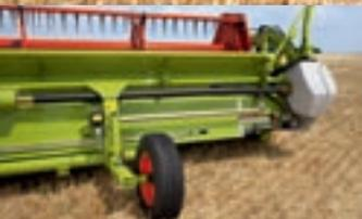
Le châssis MAXFLO amortit les mouvements de la barre de coupe.
