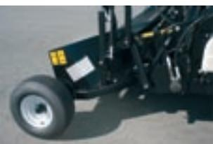
Des roues de jauge se chargent de limiter la hauteur minimale de ramassage.
