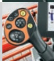
Les automatismes de coupe peuvent être activés aisément à l'aide de la touche du levier multifonctions affectée à la régulation de hauteur.
