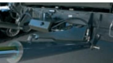
Seuls deux vérins se chargent de moduler avec précision la pression d'appui de la barre de coupe.
