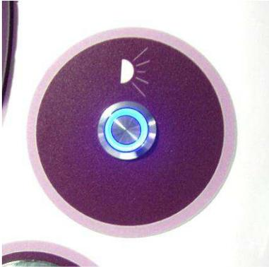
Le bouton de commande comprend les fonctions : Marche/Arrêt / Défilement des 7 couleurs / Arrêt sur couleur.
