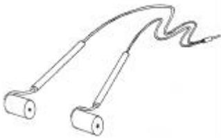
On peut également utiliser les petits rouleaux métalliques, recouverts de viscosse ou sans aucun revêtement. Les électrodes en forme de rouleau s'utilisent la plupart du temps par paires, la première étant reliée à la sortie positive et l'autre à la sortie négative de l'appareil.
