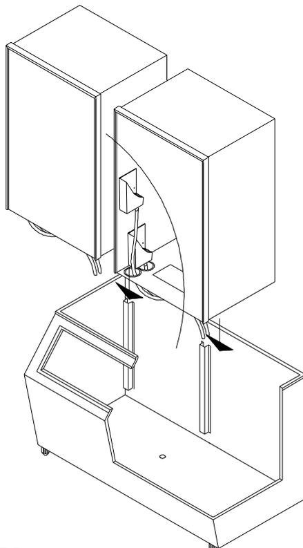
Si l'on installe un ou plusieurs machines Quasar Modular 200 sur n'importe quel dépôts à glaçons ITV, il est recommandé de faire passer les tuyaux de vidange du bac à glaçons par l'intérieur du dépôt, comme l'on voit sur la figure.
