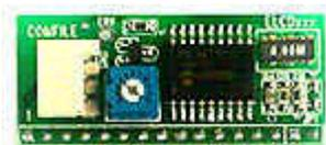
Respectez le brochage indiqué sur la figure ci-avant pour câbler le module de commande directement derrière votre afficheur et au plus court (0,5 cm max. – L'afficheur et le module de commande ne doivent pas être déportés l'un de l'autre).
