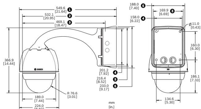
Dimensions de l'AUTODOME 7000 – suspendue, sur tube
