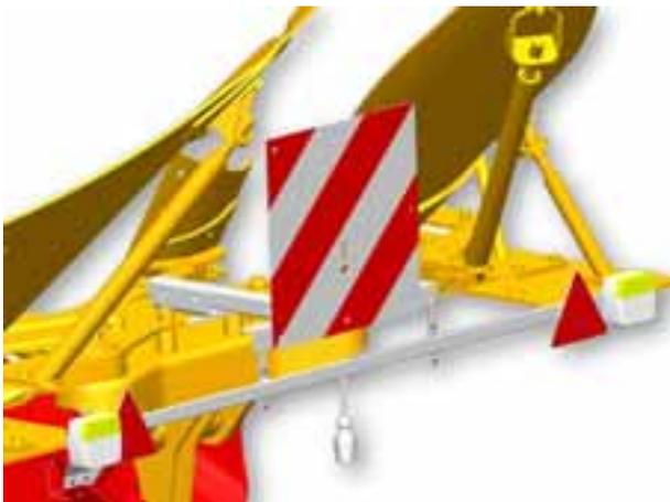
En **sécurité T**, fixation du support de rampe sur le porte-étançon du corps arrière.
