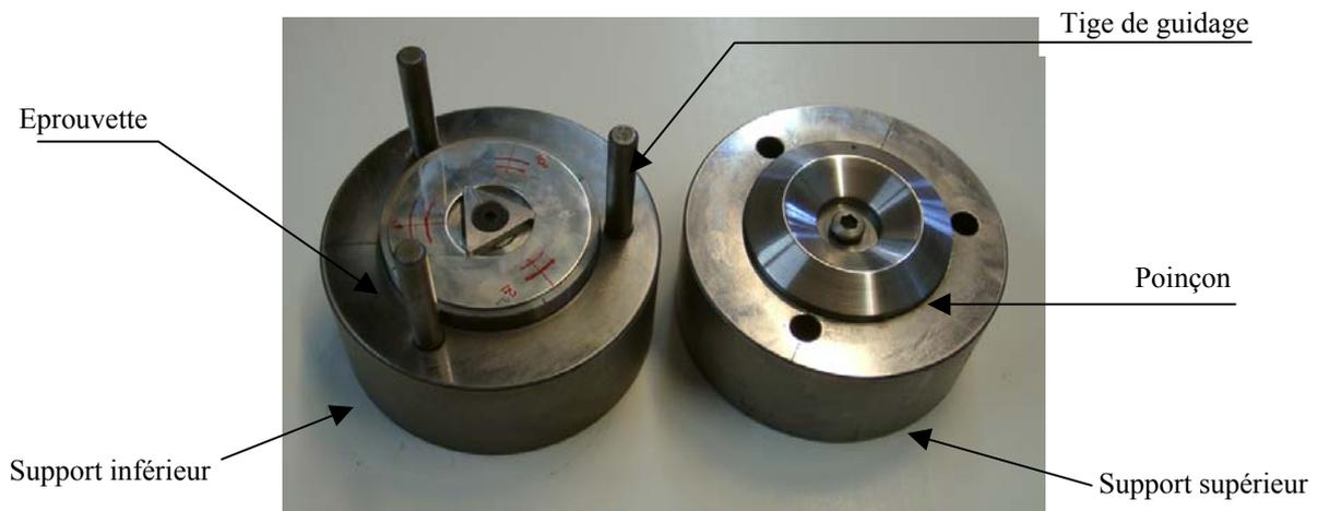
Figure 37 : Supports d'éprouvettes pour l'indentation torique
