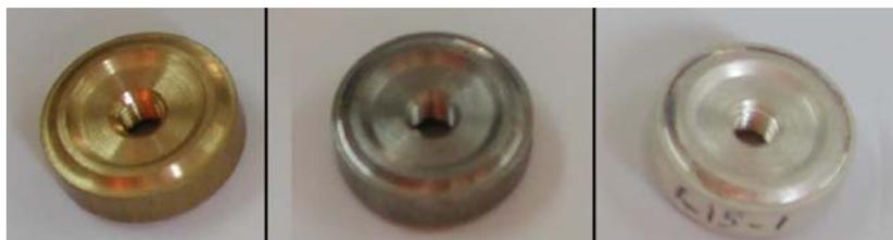
**Figure 86 : Éprouvettes pour la visualisation de l'aire réelle de contact sous charge. De gauche à droite, les éprouvettes sont respectivement en laiton, en acier en laiton revêtu d'argent ( $h = 20 \mu\text{m}$ ).**
