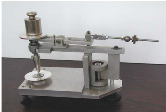
Figure 62 : Dispositif d'indentation sphérique soumis à une charge de 500g.
