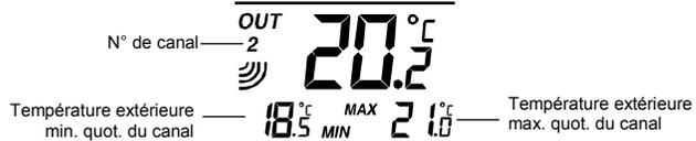
Pour afficher la température min et max quotidienne d'un autre canal, appuyer sur CH/- dans le mode d'affichage normal.
