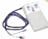
existe avec boîtier électronique indiquant placement correct des mains, bonne profondeur de compression, volume d'air insufflé suffisant
