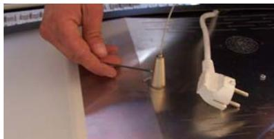
Afin d'éviter de supporter l'intégralité du poids de LUXIMA, il faut le monter progressivement : pour cela, placez-vous sur le côté latéral de LUXIMA, soulevez-le de 15-20 centimètres, et tirez les câbles pour les tendre. Reproduisez la même opération en vous plaçant sur le côté opposé. Et ainsi de suite... Ce mode opératoire évite de porter LUXIMA.
