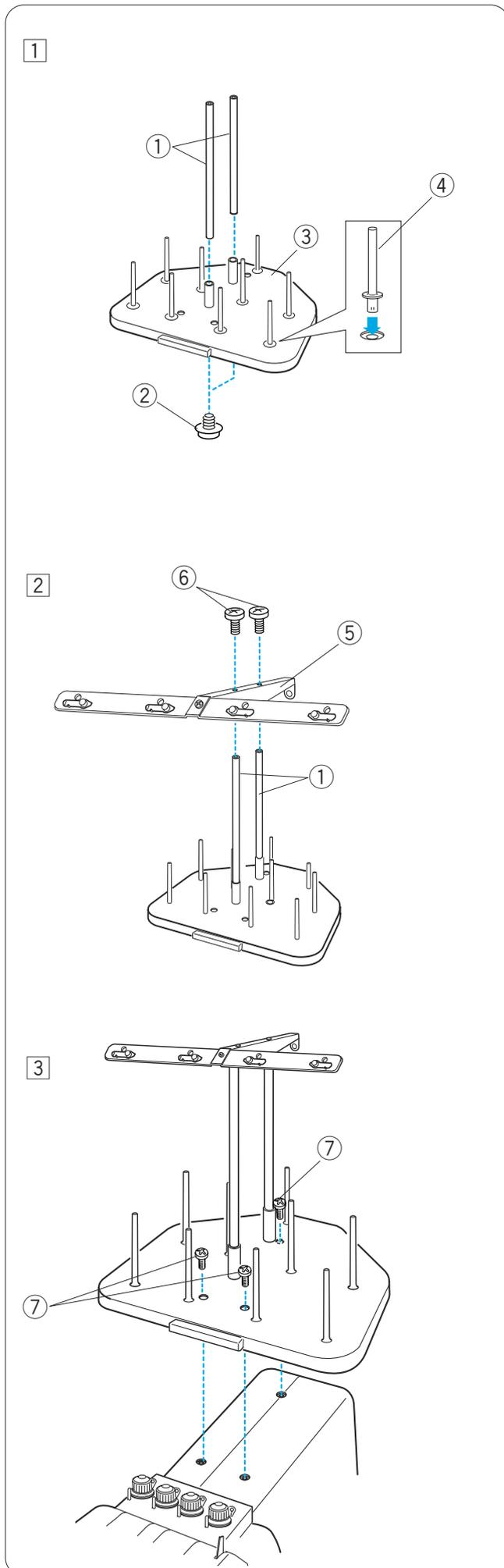
1 Insérez les montants du guide-fil dans les douilles de la plaque porte-bobines. Fixez les montants au moyen de vis de fixation (A) par-dessous. Introduisez les broches porte-bobine dans la plaque porte-bobines.
