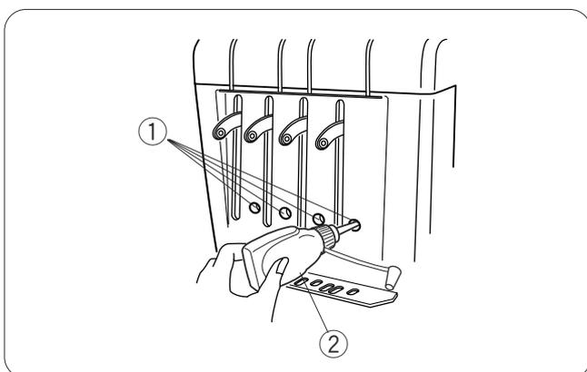
Appliquez quelques gouttes d'huile sur la barre à aiguille par les orifices du couvercle avant.
