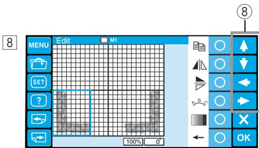
8 Déplacez le motif inversé dans l'angle en bas à gauche de la fenêtre d'édition en utilisant les touches fléchées ou en le faisant glisser avec le doigt.
