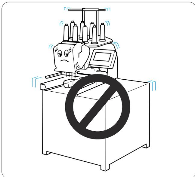
Placez la machine sur une surface plane et horizontale.
