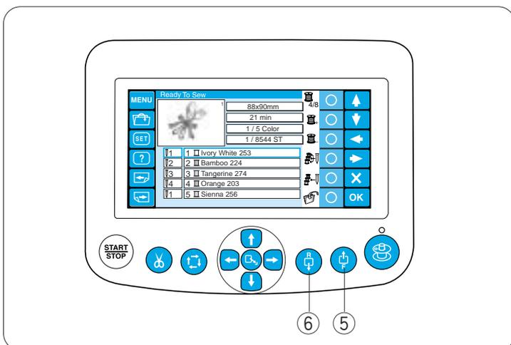
Si le fil casse ou vient à manquer en cours de broderie, la machine s'arrête automatiquement et le cadre à broder revient à la position où le fil a cassé ou s'est terminé.
